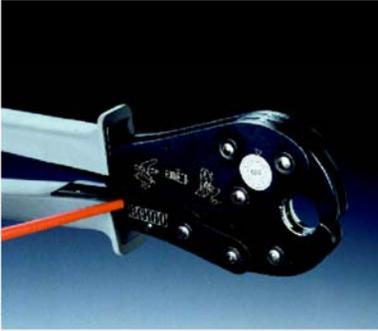
Para garantizar una unión por compresión completa, las herramientas de REHAU RAUBASIC press Tool recién se abren cuando se ha completado el proceso de unión. Si en caso de manejo erróneo fuera necesario abrir la herramienta antes de tiempo, es posible soltar la traba entre los brazos de la palanca (tornillo de ranura) con un destornillador.
