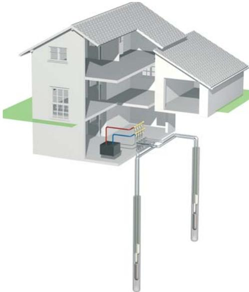
Por regla general, las sondas geotérmicas se instalan hasta una profundidad de 150 m, para así aprovechar las temperaturas constantes del subsuelo de forma eficaz para la obtención de energía.
